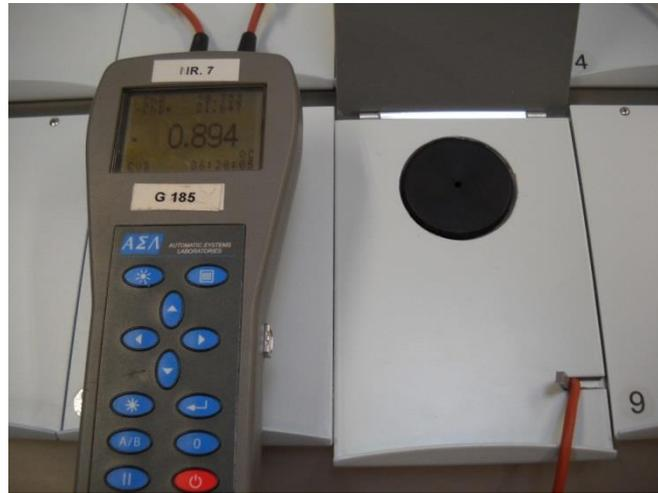
6. Versetzen Sie den Temperatursensor in Kammer 3 oder 8 und justieren Sie  $t_{n-3}$  wie unter Punkt 4 beschrieben (siehe auch Abschnitt 7.7).
