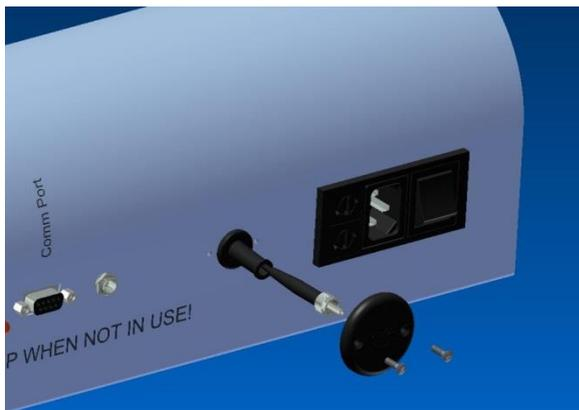
Der Lichtwellenleiter ist an einer Abdeckplatte an der Geräterückseite befestigt.
