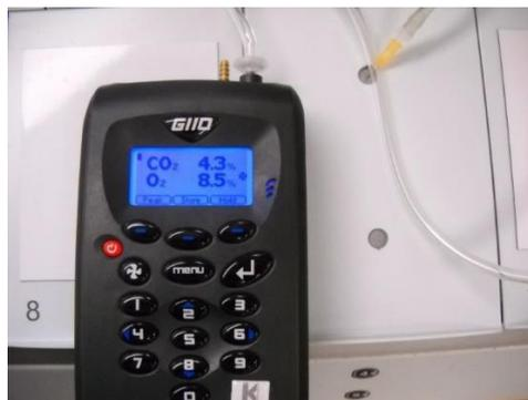
Compare la lectura de CO<sub>2</sub> con el valor que se muestra en el menú 'CO<sub>2</sub>.C' y ajústelo si es necesario, consulte la sección 7.7.
